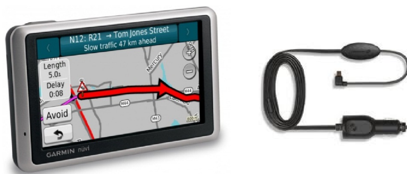
Mynd 6.5 Leiðsögutæki með TMC ásamt FM móttakara
