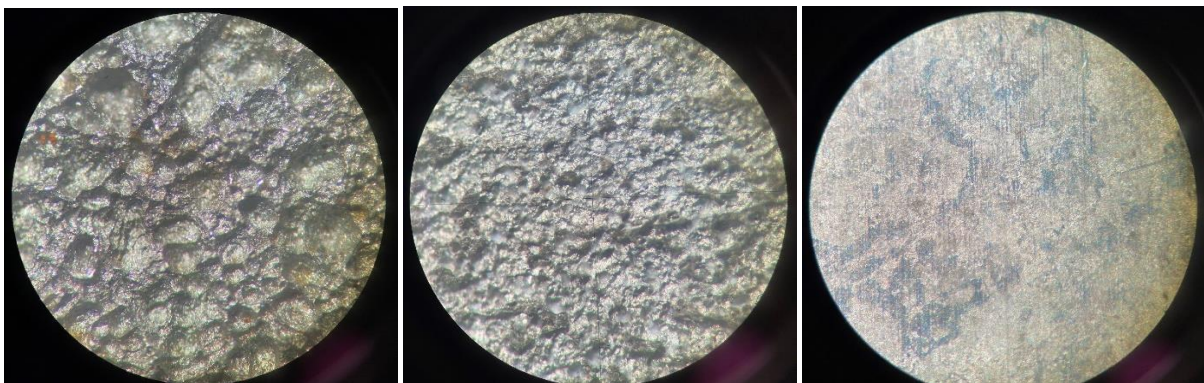
Mynd 5 Smásjármyndir af stálsýni, sínskýni og álsýni eftir 18 ára tæringu. Pittatæring áberandi í stáli og sínski.
