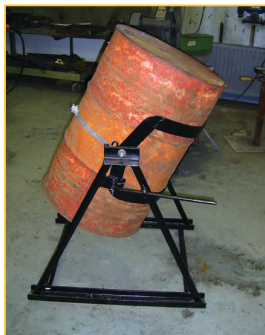
Tunnuhaldari sem starfsmaður Vegagerðarinnar hannaði og smíðaði undir úrgangsolíutunnur. Tunnuhaldarinn heldur tunnunni ávallt uppréttri þannig að ekki sé hætt á leka í niðurföll (PB).
