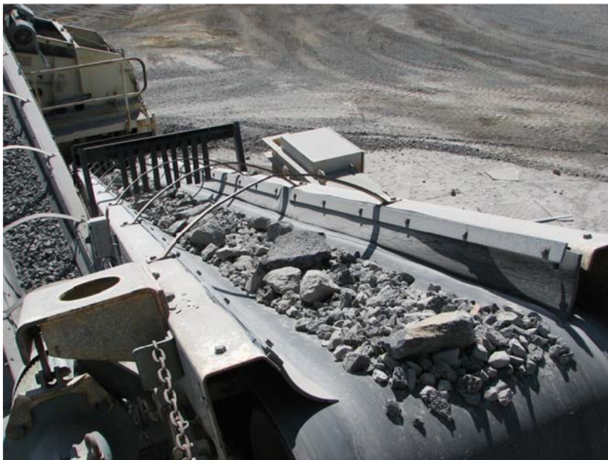
Mynd 3. Steinefnið er búið að brjóta í forbrjót og er búið að fara gegnum hörpu. Og er nú á leiðinni yfir í kónbrjót. Á færibandinu má einnig sjá töluvert af stærri kornastærðum en þær tilheyra yfirstærðarefni.
