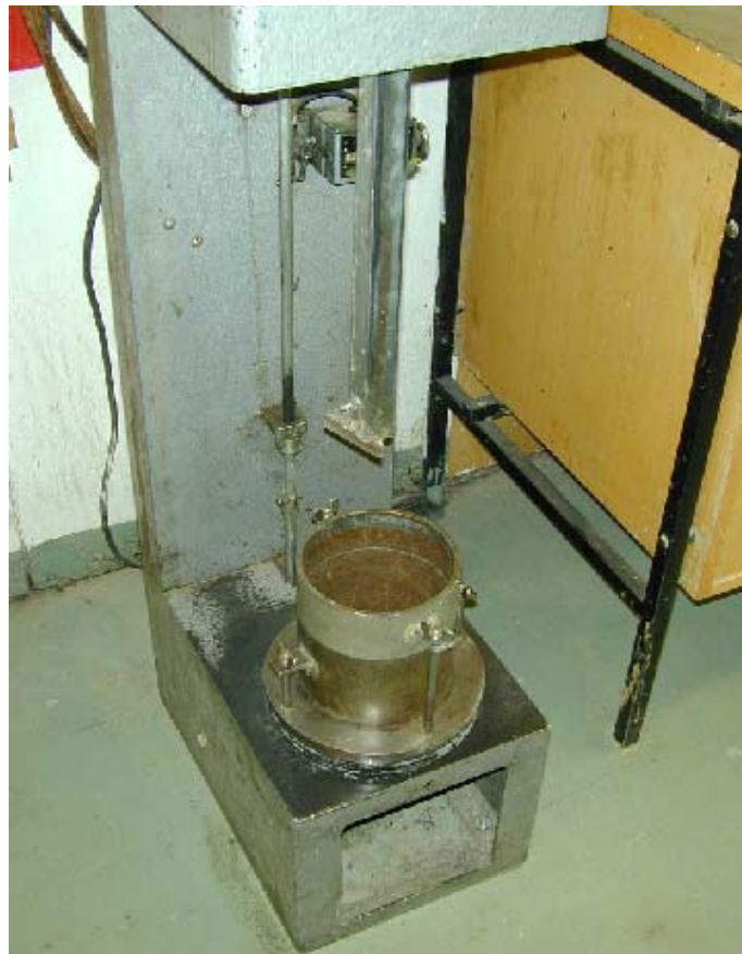
MYND 1 Ljósmynd af proctor hamri sem beitt er við ákvörðun Bg-stuðuls
