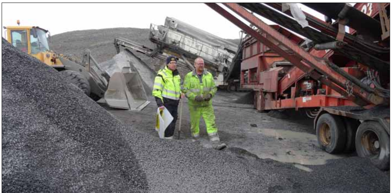
Efnisvinnsla í Bláhæð á Holtavörðuhæði 11. júní 2014. Sýni tekið úr framleiðslunni. Jón Helgi Helgason verkefnastjóri hjá Vegagerðinni í Borgarnesi og Gísli Jósefsson verkstjóri hjá Tak. Mynd: Hafðís Eygló Jónsdóttir.
