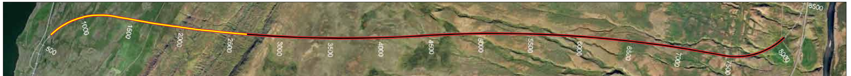
Vaðlaheiðargöng, staða framkvæmda 24. mars 2014. Búið er að sprengja 2.013 m frá Eyjafirði sem er 28,1% af heildarlengd.
