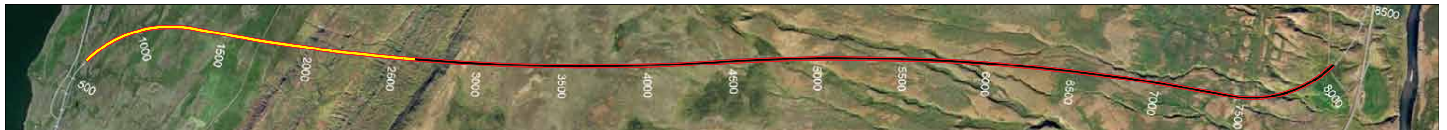
Vaðlaheiðargöng, staða framkvæmda 17. mars 2014. Búið er að sprengja 1.991 m frá Eyjafirði sem er 27,8% af heildarlengd.
