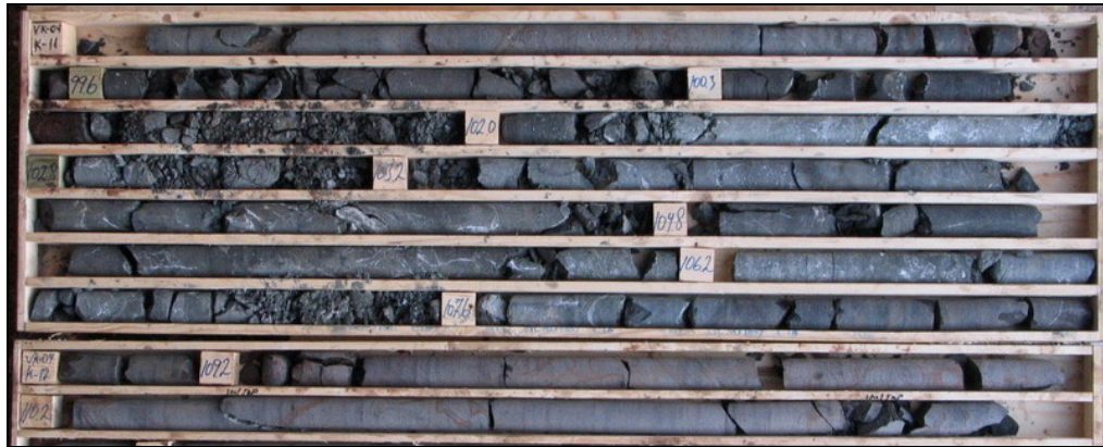
Mynd 31. Misgengisbreksía á liðlega 100m dýpi í borholu VK-04. Útfellingar hafa sest í flestar sprungur en lektarprófanir á þessum stað sýna að bergið er samt opið fyrir lekt.
