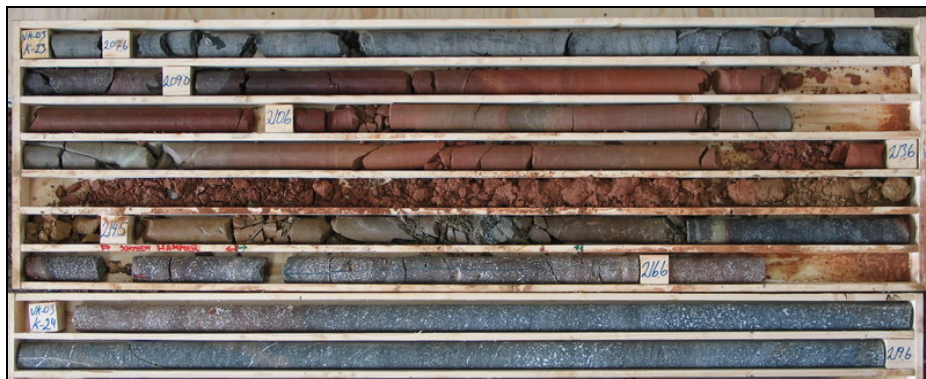
Mynd 27. Setberg með lágan bergstyrk á liðlega 200m dýpi í borholu VK-03. Efst er hóleiðbasalt, rauðbrúna- og brúna bergið er setberg og neðst er kargi og blöðrótt dílabasalt með miklum útfellingum í blöðrum og holum. Sjá einnig teikningu af helstu tæknilegu þáttum berglaga á mynd 23. Miðað er við að göngin fari undir þesi selög án þes að skera þau.
