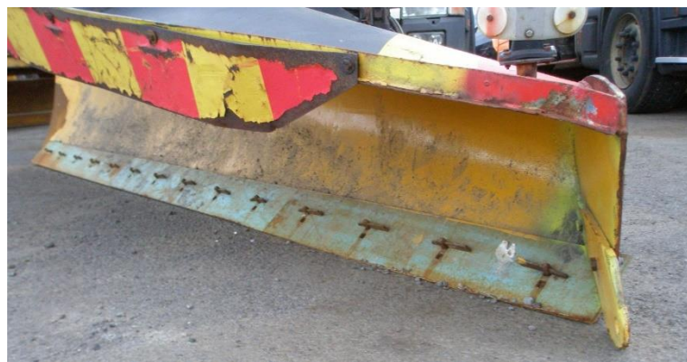
Mynd 11 - Snjótönn með stál slitblaði.
