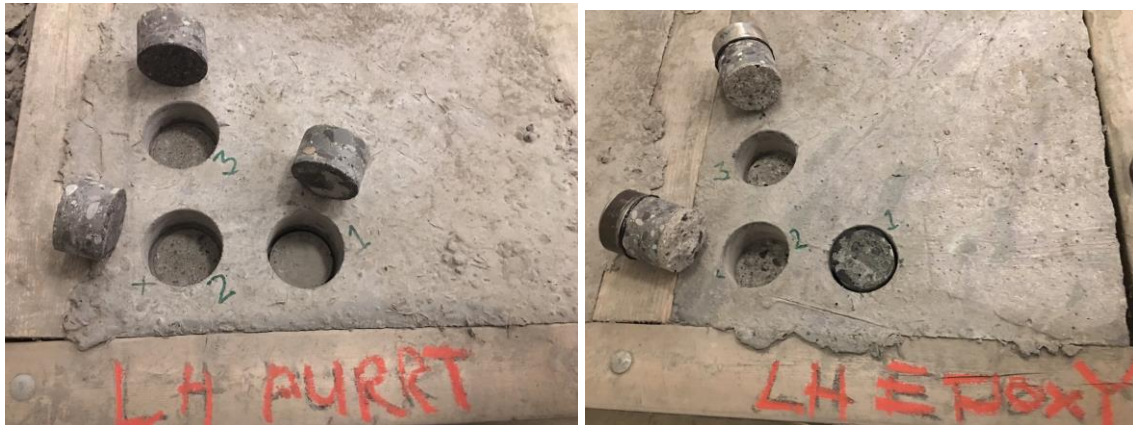
Mynd 29, prufusteypur úr fylliefnum frá Litla Horni steypar á þurrt yfirborð eða tveggja þátta lím
