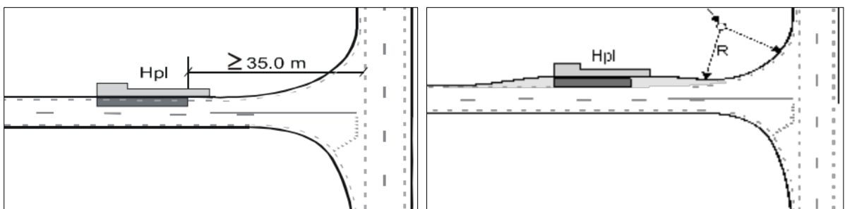
Mynd 34: T.v. Stoppistöð á akrein hliðarvegar eftir vegamót. T.h. Strætóvasi á hliðarvegi eftir vegamót.
