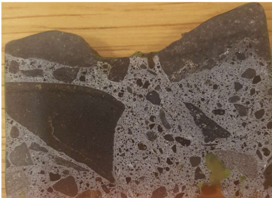
Mynd 19. Óseyrarbrú, sýnið er úr neðri fjörumörkum. Sýni 14, sýnið sem rannsakað var með rafeindasmásjá. Sýnið er 2,8 x 5,0 cm á stærð. Yfirborðið er upp. Áætlað er að um 30 mm hafi flagnað af sýninu.
