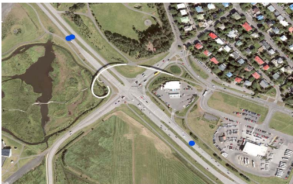
Mynd 4.4.1 Gatnamót Hringbrautar og Njarðargötu. Staðsetning TASS skynjara merkt með bláum punkti.
