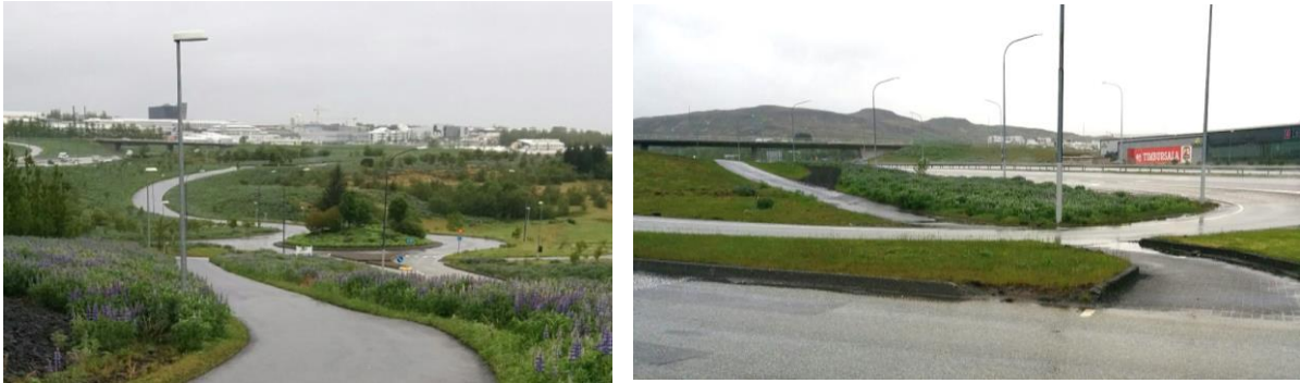
Mynd 3-6: T.v. er dæmi um stíglýsingu (við Keldnatorg), t.h. er dæmi um stað þar sem stíglýsingu er sleppt af því að götulýsing nægir (við mót Víkurvegjar og Vesturlandsvegjar).
