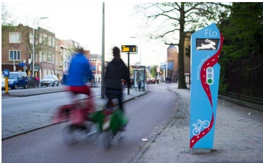
Mynd 3-11: Umferðarljós staðsett nálægt gatnamótum hjálpa hjólandi vegfarendum að gera sér grein fyrir hvort þeir þurfi að hægja á sér, (skjaldbaka), hraða á sér (héri), eða halda sama hraða (þumall) til að ná næsta græna ljósi (Citylab, 2017)
