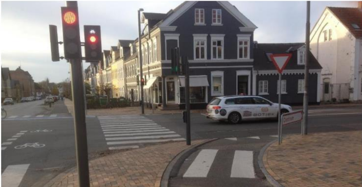
Mynd 2-2: Myndin sýnir útfærslu á forgangi þar sem hjólreiðafólk sem er að beygja til hægri er tekið út fyrir ljósastryngar (Vejregelgruppen Byernes trafikarealer, 2016, bls. 39).
