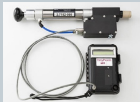
Tiny Perm mælir sem notaður var til lektarmælinga.
