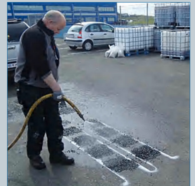
Reitapróf (lappetest) með steinefnum sem ætlað var að leggja út í bikþeytutilraunum Vatni sprautað á fletina eftir að allt hafði verið lagt út.
