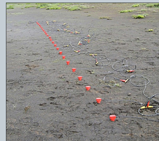
Dæmigerður MASW mælingaprófill. Röð 24 „geophones“ með jöfnu millibili.
