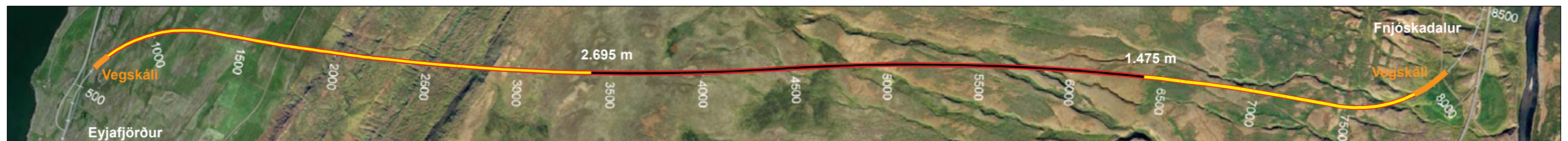
Vaddlaheiðargöng, gangagröftur liggur niðri á meðan átt er við vatnsleka. Búið er að sprengja samtals 4.170 m sem er 57,8% af heildarlengd.
