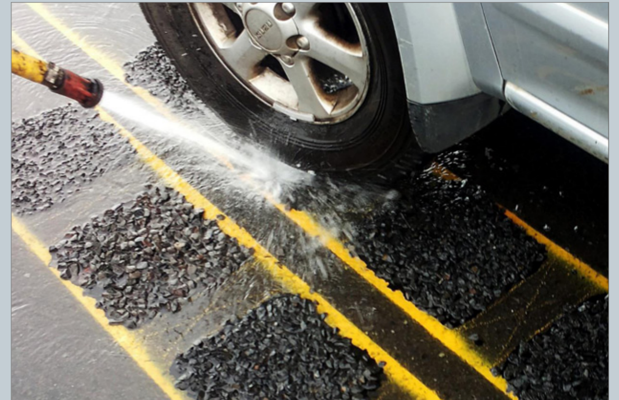
Reitapróf (lappetest). Jeppadekki snúid á reit með vatnsálagi.
