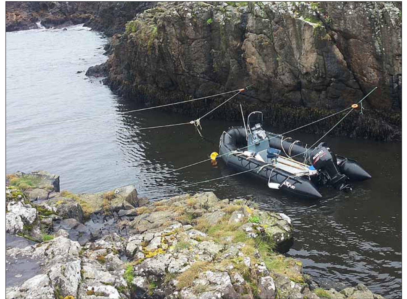
Myndin sýnir nýjan bát sem var keyptur fyrir vitadeild Vegagerðinnar sl. vor. Þetta er Zodiac linbotna neopranebátur (gúmbátur) HD, lengd 5,85 m, breidd 2,50 m, motor Zuzuki 140 hestöfl fjörgengisvél. Áður voru leigð varðskip í viðhaldsverkefni vita sem vinna þurfti af sjó en báturinn leysir þau að miklu leyti af hólmi. Myndin er tekin í Papey.
