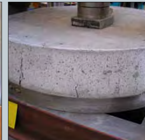
Mælingar á orkugleypni í 2000 kN brotpressu MANNVITS á ferköntuðu 600 mm sýni samkvæmt evrópska sprautusteyputaðlinum (myndin til vinstri) og á 600 mm kringlóttu sýni samkvæmt norsku sprautusteypu-leiðbeiningunum (myndin til hægri).
