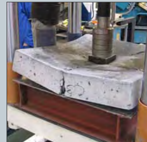
Mælingar á orkugleypni í 2000 kN brotpressu MANNVITS á ferköntuðu 600 mm sýni samkvæmt evrópska sprautusteyputaðlinum (myndin til vinstri) og á 600 mm kringlóttu sýni samkvæmt norsku sprautusteypu-leiðbeiningunum (myndin til hægri).
