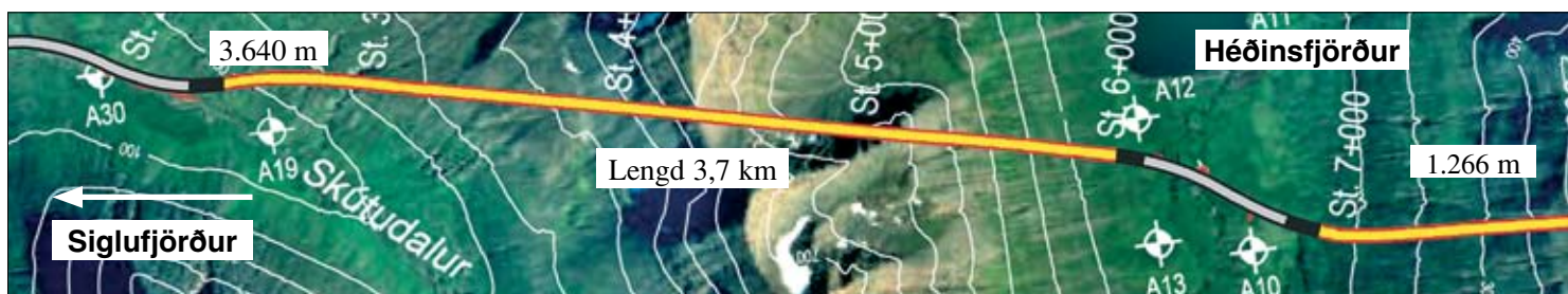
Staða framkvæmda við Héðinsfjarðargöng 6. okt. 2008. Sprengingum frá Siglufirði til Héðinsfjarðar lauk 21. mars 2008.
