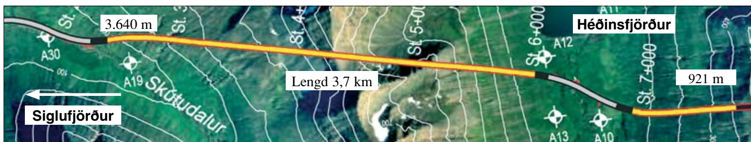
Staða framkvæmda við Héðinsfjarðargöng 25. ágúst 2008. Sprengingum frá Siglufirði til Héðinsfjarðar lauk 21. mars 2008.
