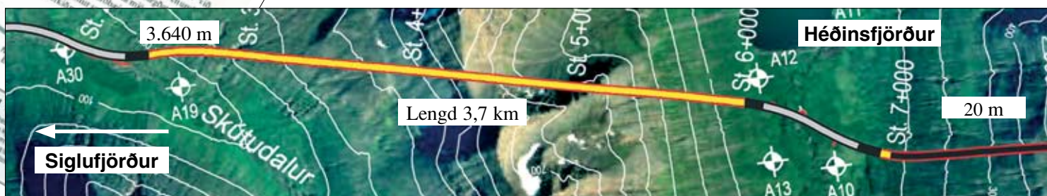
Staða framkvæmda við Héðinsfjarðargöng 19. maí. 2008. Sprengingum frá Siglufirði til Héðinsfjarðar lauk 21. mars 2008.
