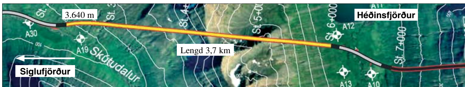
Staða framkvæmda við Héðinsfjarðargöng 7. apríl. 2008. Búið er að sprengja 3.640 m í Siglufirði og 2.768 m í Ólafsfirði.
