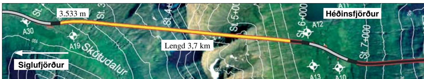
Staða framkvæmda við Héðinsfjarðargöng 10. mars. 2008. Búið er að sprengja 3.533 m í Siglufirði og 2.633 m í Ólafsfirði.
