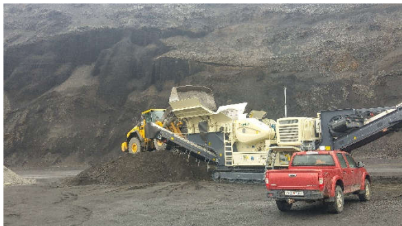
Mynd 1 Efnið var fyrst forbrotið í kjaltbrjót Metso LT 120. Mynd 2 Síðan fór efnið í kónbrjót Metso LT 330.
