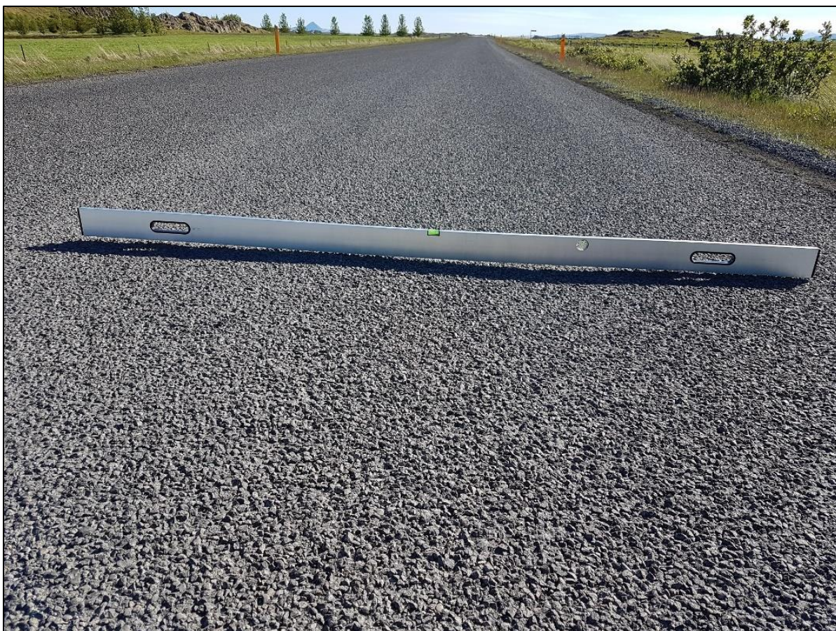
Mynd 7 Mæling á hjólfaramyndun í tveggja daga gamalli klæðingu
