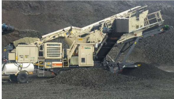
Mynd 4 Steypuafganagnar malaðir með kónbrjót 9
