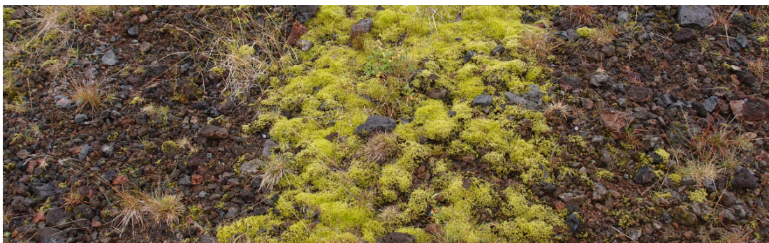
Mynd 19. Fimm ára gamall tilraunareitur á Hellisheiði þar sem tættri gróðurtorfu var dreift yfir ógróinn vegfláa í hlutföllunum 1:50 (0,04 m 2 torfa á 2 m 2 reit).
