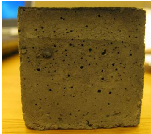
Mynd 23: Rakaskil eftir hitun í ofni.
