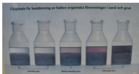
Mynd 14: Litaskali fyrir húmuspróf samkvæmt ASTM D1544.
