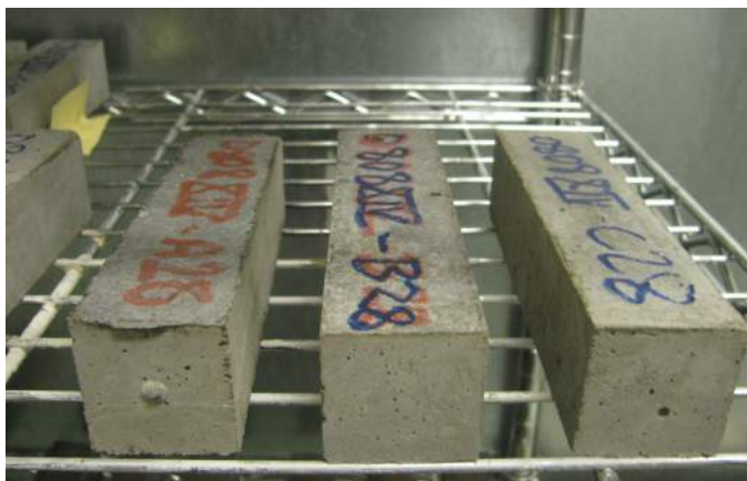
Mynd 34: Útskipting ösku fyrir slag (GGBS) skilaði sér í þéttari strendingum.
