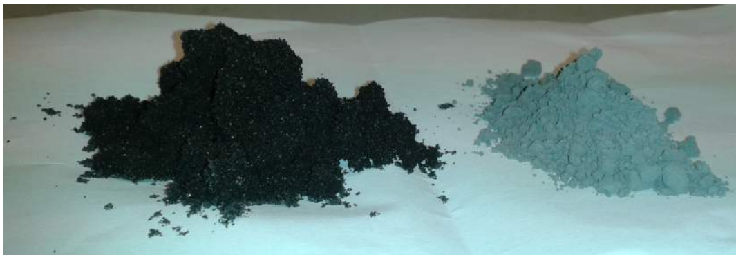
Mynd 8: Blaut, ómulin eldfjallaaska til vinstri og þurrkuð mulin aska til hægri.
