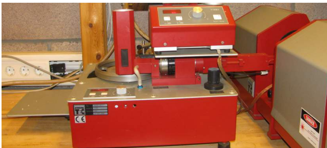
Mynd 1: Sympatec Helos kornastærðardreifingarmælitæki.
