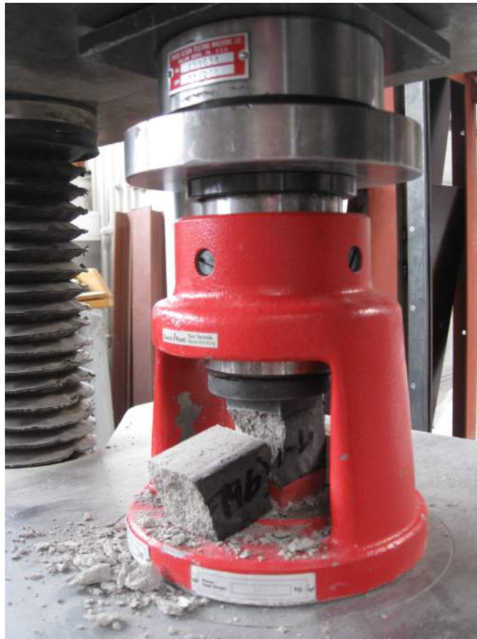
Mynd 7: Tinius Olsen brotþolspressan sem notuð var í verkefni.
