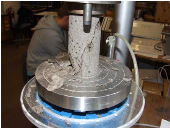
Sample nr. 13: Olivine tholeiite, \sigma_c = 40,85 MPa.
