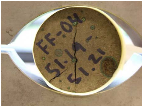
Sample nr. 28: Olivine tholeiite, \sigma_t = 2,08 MPa.
