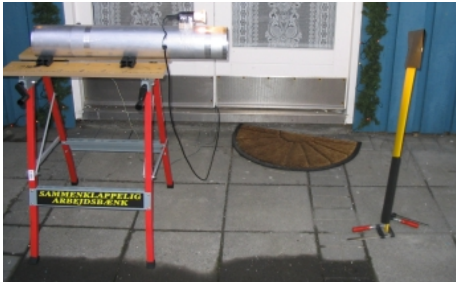
Mynd 5. Uppsetning búnaðar við prófanir á áhrifa litar vegstiku á mælingar.
