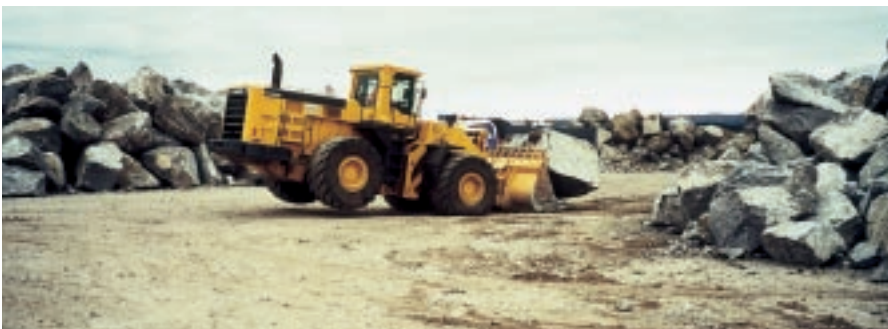
Mynd 8.9: Grjótnám frá Sirevaag í Noregi, sem sýnir vinnslu á mjög stóru grjóti, allt að 20 - 30 tonn.
