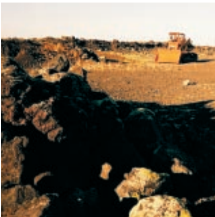
Mynd 8.12: Hraunnáma við Krýsuvíkurveg. Yfirborðsvinnsla brauna er óæskileg vegna þess hve lítið efni fæst miðað við það svæði sem raskað er.
