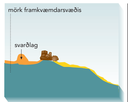
Mynd 7.7: Að efnistöku lokinni er efnistökusvæði mótað og jarðveginum jafnað aftur yfir svæðið, þannig að minnst 0,2 m þykkt jarðvegslag þeki það. Landmótun lokið.
