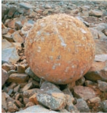
Mynd 8.8: Stálkúla sem notuð er til að brjóta stórgrýti í nýtanlegar stærðir.
