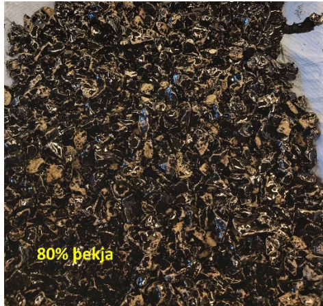
Mynd 1 Dæmi um niðurstöður viðloðunarprófs á steinefni ætlað í klæðingu. Báðar myndir eru af efni úr námunni Ofan Kleifabúa en notað var sitt hvort viðloðunarefnið.
