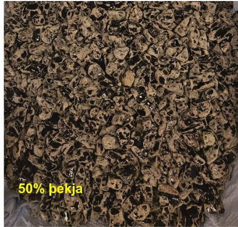
Mynd 1 Dæmi um niðurstöður viðloðunarprófs á steinefni ætlað í klæðingu. Báðar myndir eru af efni úr námunni Ofan Kleifabúa en notað var sitt hvort viðloðunarefnið.
