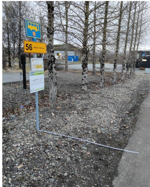
Mynd 3.2 Stoppistöð á tjaldsvæði Egilsstaða. Hér er um 1,8 metrar frá malbiki að tímatöflu staur.
