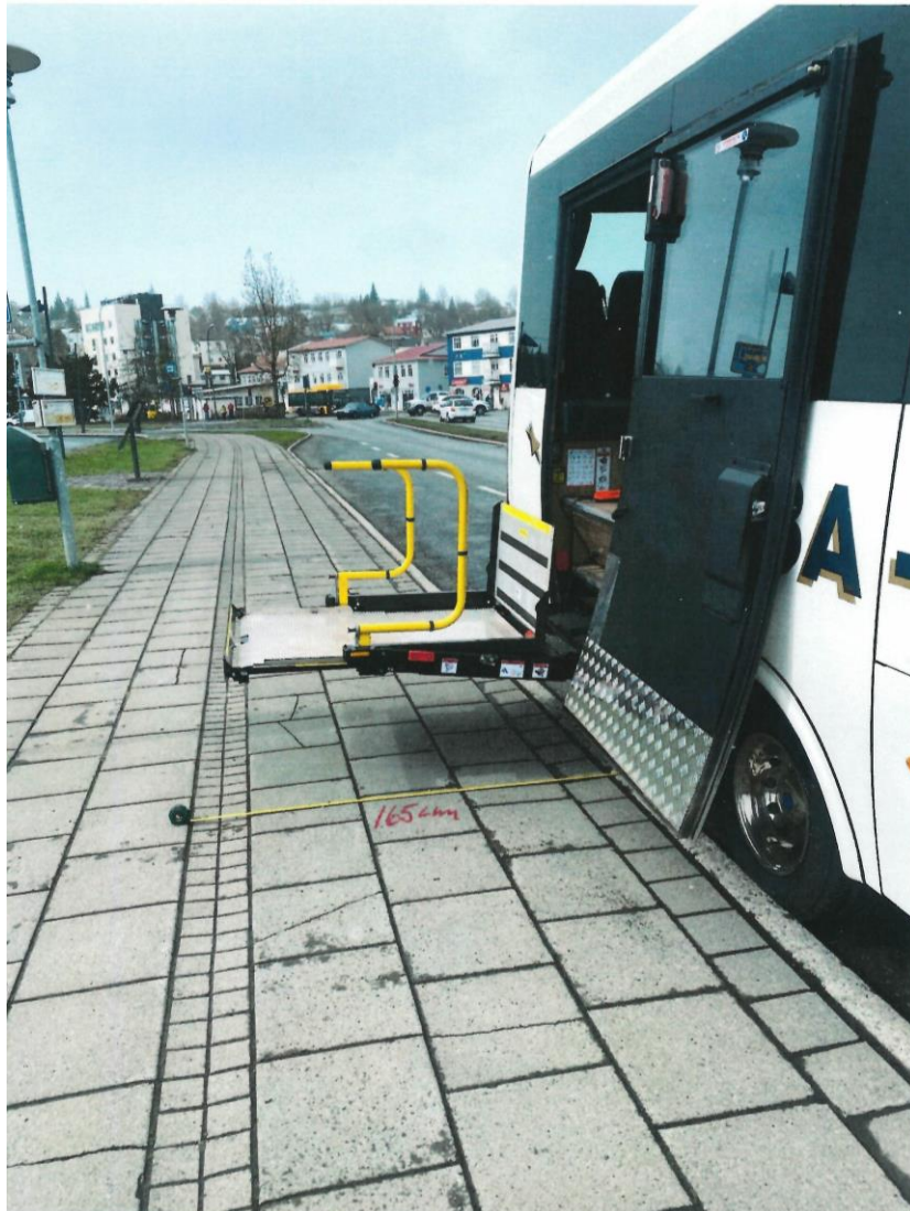
Mynd 3.1 Mæling á hjólastólalyfta í vagni SBA á Akureyri (Vegagerðin, 2022).
