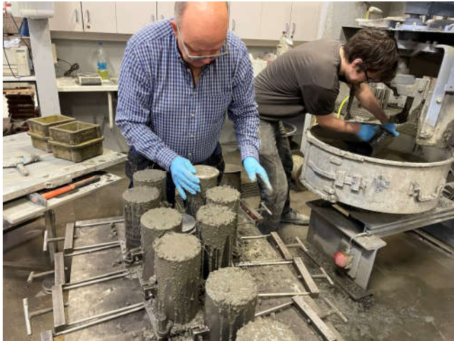
Mynd 10. Stórir sívalingar fyrir fjaðurstuðul (E-modul), Mynd 11. Steypa sett í mót fyrir rýrnunarsýni og litlir sívalingar fyrir þrýstistyrk.
