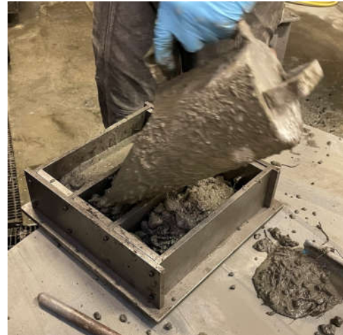
Mynd 10. Stórir sívalingar fyrir fjaðurstuðul (E-modul), Mynd 11. Steypa sett í mót fyrir rýrnunarsýni og litlir sívalingar fyrir þrýstistyrk.
