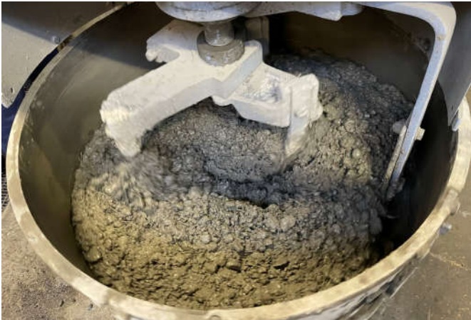
Mynd 5. Prófsteypa sem er verið að hræra saman, sem var á þessum tímapunkti frekar seig.
