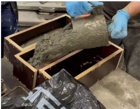
Mynd 12. Steypa sett í mót fyrir beygjutogþolsýni.
