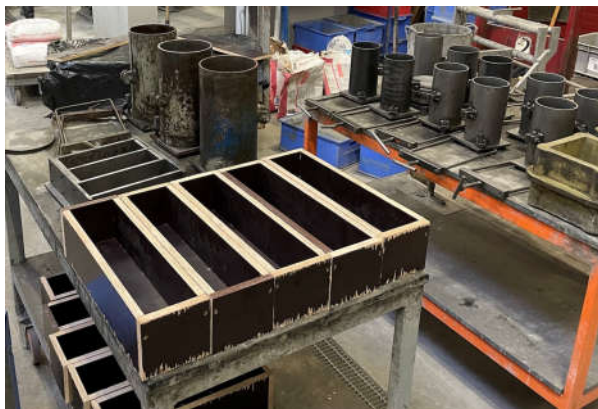
Mynd 9. Mótin sem notuð voru fyrir beygjutogþolssýni, ásamt mótum fyrir rýrnunarsýni, fjaðurstuðuls-, frostþols- og þrýstistyrksmælingar.
