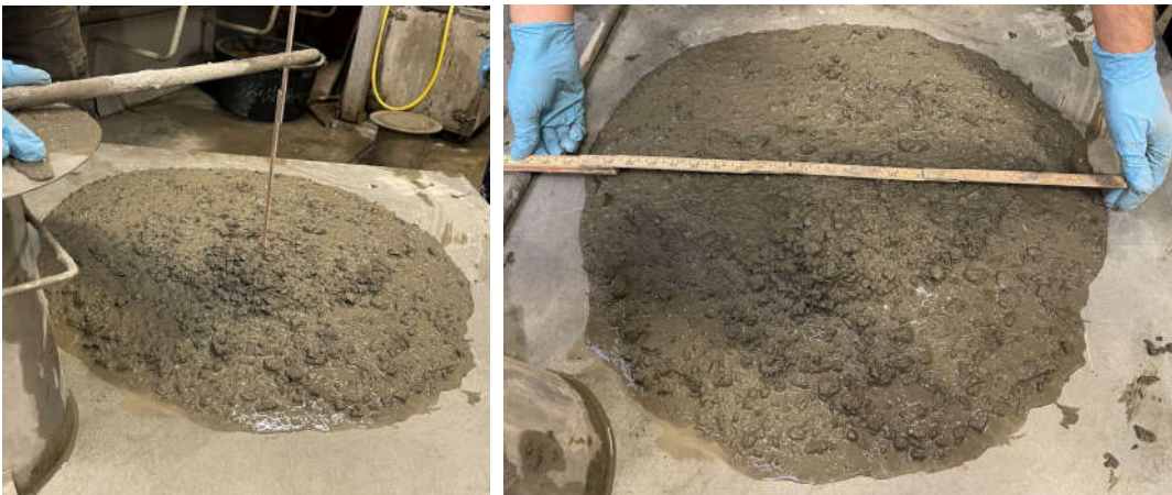
Myndir 6 og 7. Sigmálsflæði steypu, þar sem örlar á aðskilnaði
