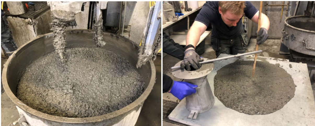
Mynd 3 og 4: Prófsteypa með Stokksnesefni útbúin (tv) og sigmál mælt (th).
