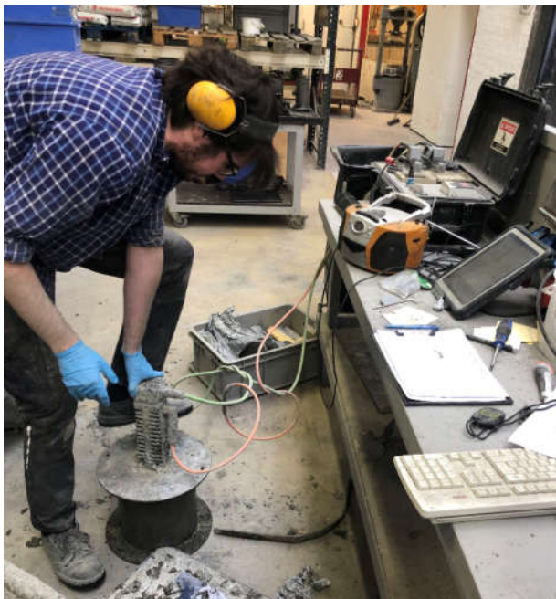
Mynd 5: Seigjumæling á prófsteypu.
