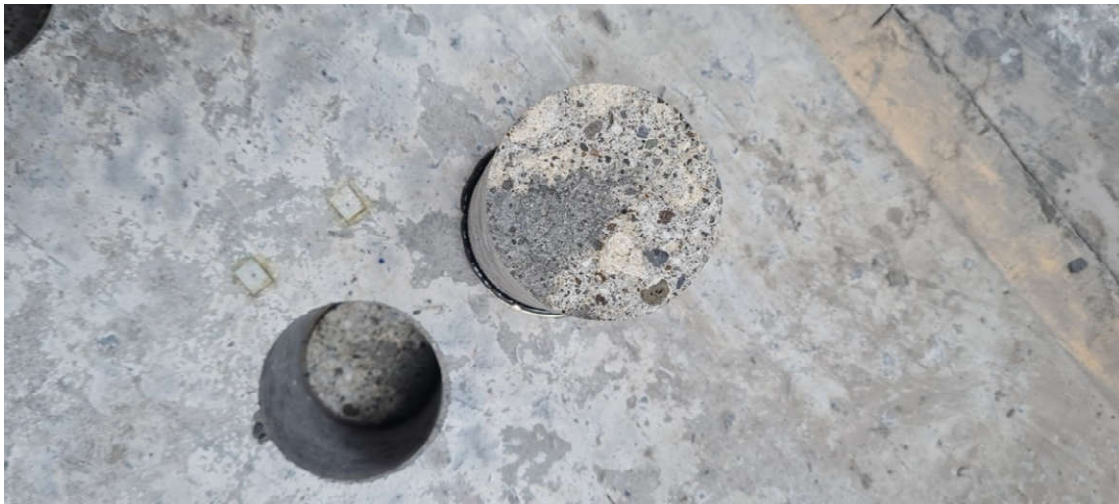
Mynd 25: Slitið varð að hluta til í undirsteypu og að hluta til í bindingi.
