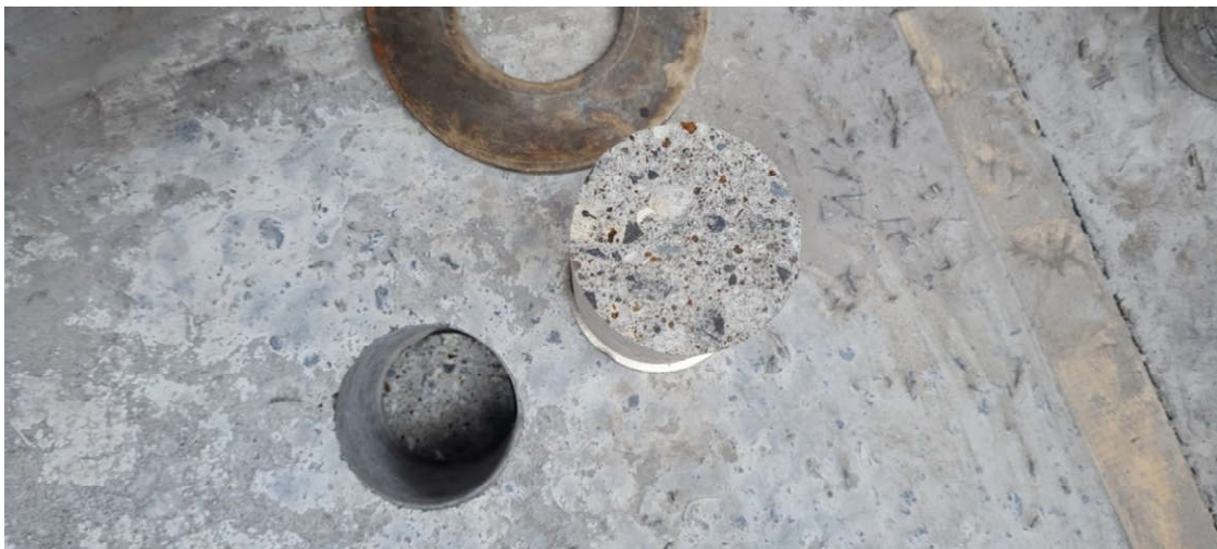
Mynd 26: Slitið átti sér alfarið stað í undirsteypunni.
