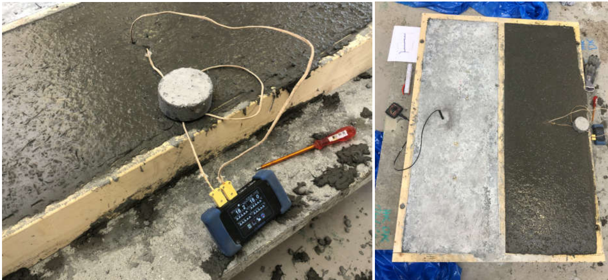
Mynd 19 og 20: Hitamælingar í slitlagssteypum.
