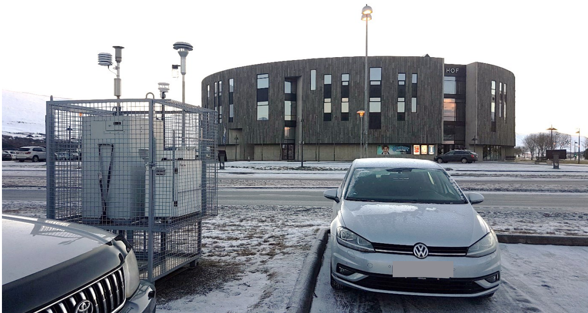
MYND 2.1 Sýnatakinn við Strandgötu. Sýnatakinn er hægra megin í búrinu og loftgæðamælir UST er vinstra megin.
