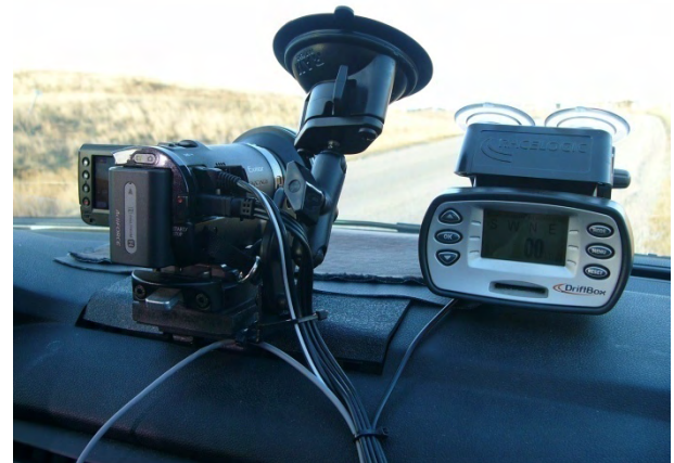
Mynd 4. Myndbandsupptökuvél sem var notuð til að taka upp myndir af vegum.
