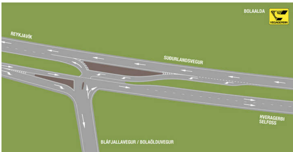
MYND 6-3 Útfærsla stefnugreindra vegamóta sem auðvelda vinstribeygju frá hliðarvegi.
