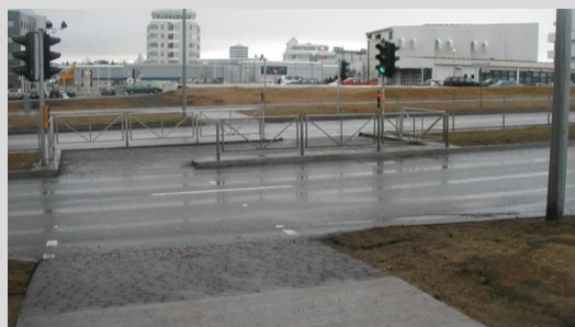
Mynd 26 Hliðfærð gönguleið. Gönguþverun með umferðarljósum yfir tvær akreinar í einu. Grindverk opið þannig að það sést í gegnum það undir litlu horni.
