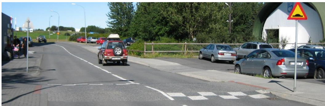
Mynd 8 Gönguþverun með upphækkun. Upphækkunin þarf að vera flöt að ofan til að tryggja aðgengi allra.
