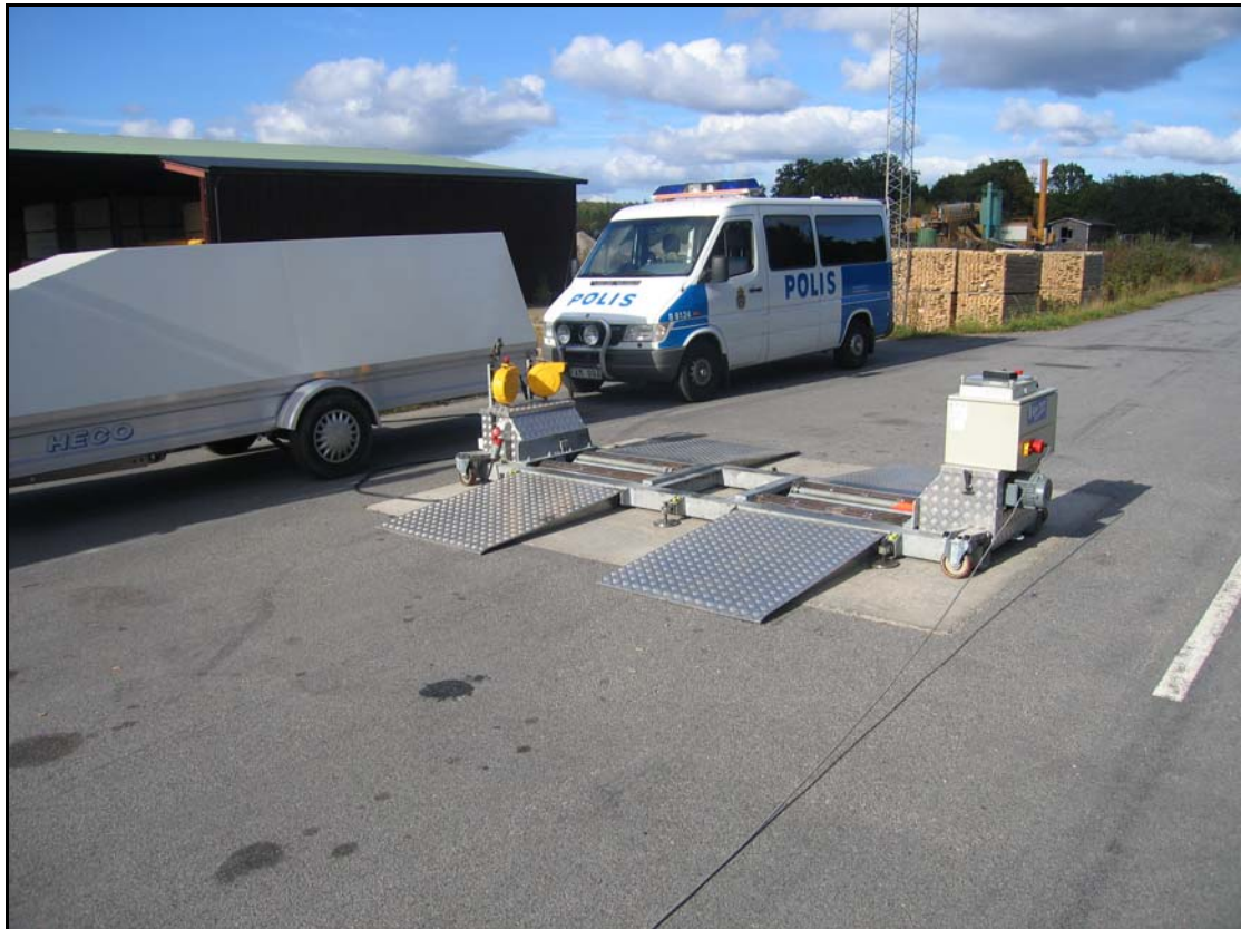
Mynd 8. Laus bremsuprófunarbúnaður á steyptri plötu á eftirlitsstað í Hurva við E22 í Sviþjóð (Ljósmynd, Sævar Ingi Jónsson).
