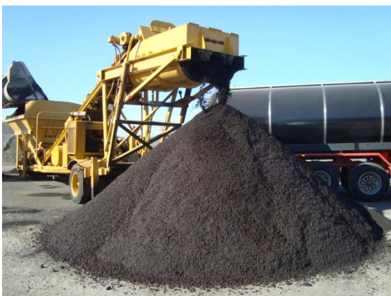
Mynd 3. Kaldblöndun í stöð. Tankur með bindiefni í baksýn.
