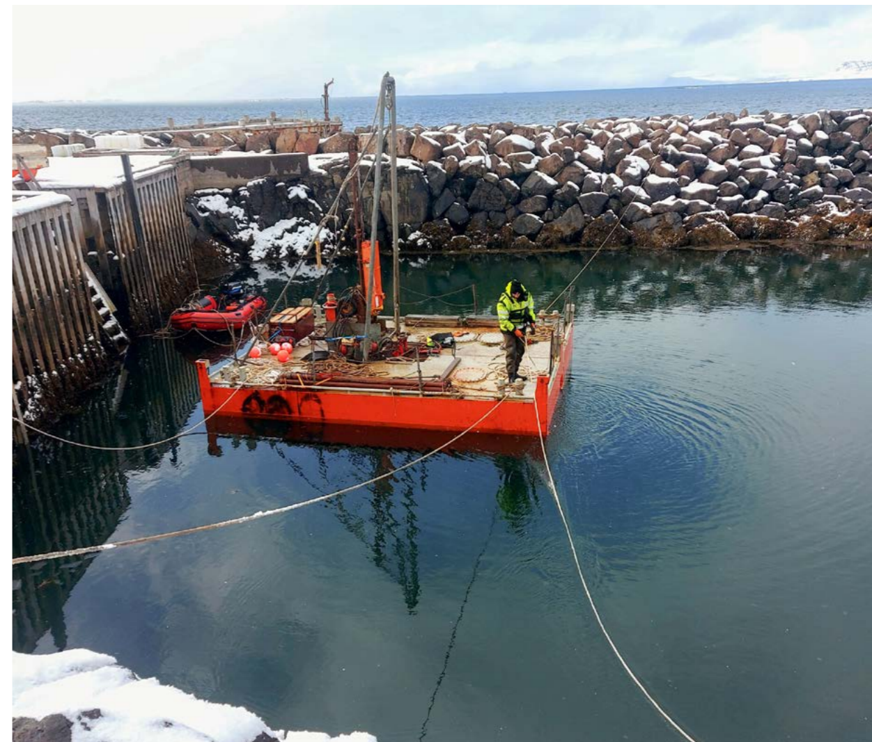
Sérsmíðaður prammi með höggbor er notaður til að mæla lagskiptingu jarðlaga og dýpi á klöpp í höfnum og fjörðum þar sem framkvæmdir standa fyrir dyrum.
