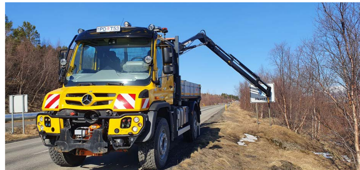
↓ Vegagerðin á Norðursvæði á Unimog sem er fjölnota tæki sem getur klippt gróður, sópað götur, mokað snjó og þvegið stíkur svo fátt eitt sé nefnt.
