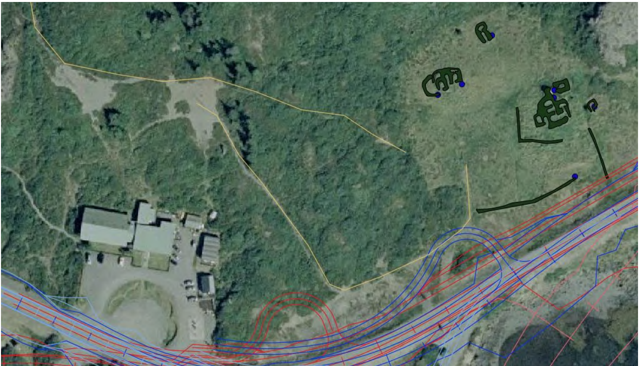
Teikning 23. Minjar á Hellu sem og leiðir sem merktar eru með gulu. Veglína A1 (blár), veglína A2 (bleik) og veglína A3.
