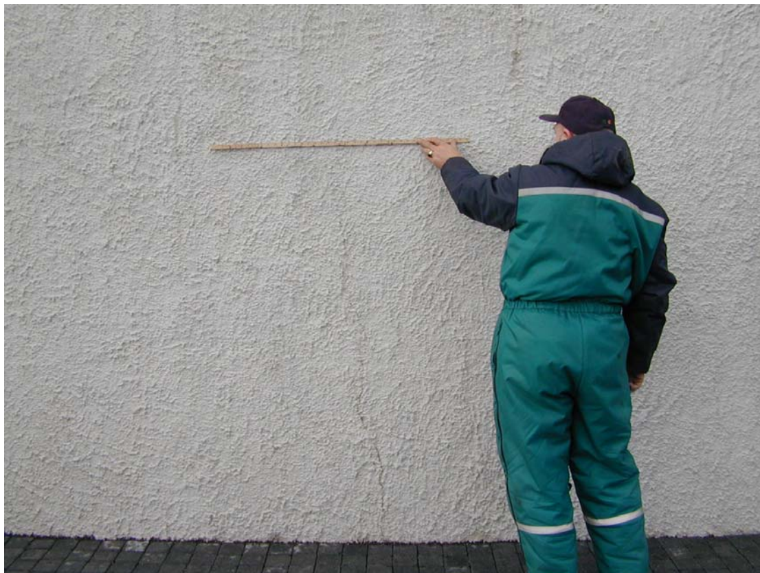
Mynd 13. Steypa með hrjúft yfirborð. Skannaðar voru 7 láréttar línur með sprunguna miðjunni. Hver lína var 1 m á lengd og bil milli mælipunkta var 10 cm. Mælistikan sýnir staðsetningu á efstu línunni.
