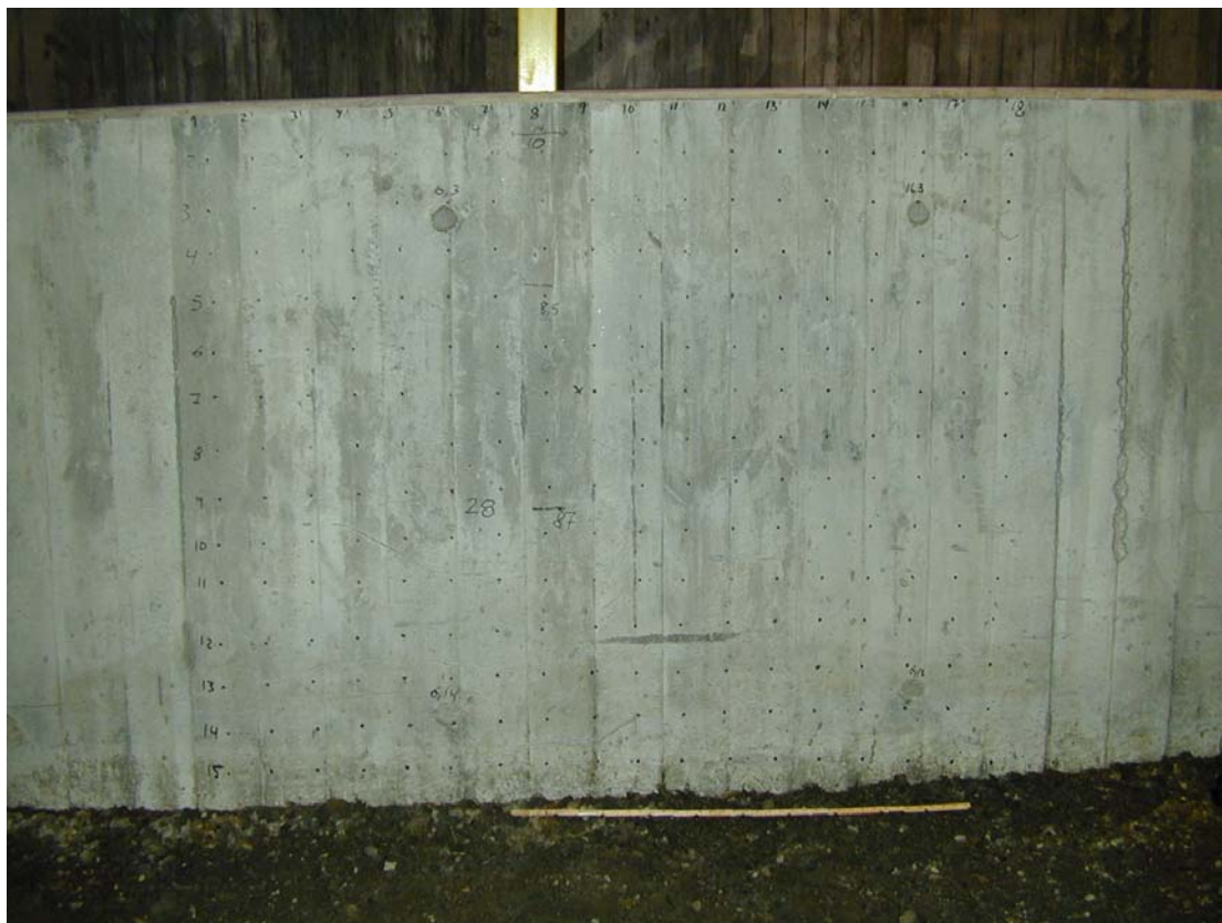
Mynd 18. Staðsetning mælipunkta – ath línur 14 og 15 voru ekki mældar. Mælt var frá efri brún eftir láréttum línunum frá vinstri til hægri, alls 13 línur. Hver lína var 1,7 m á lengd. 10 cm voru milli hvers mælipunkts. Tækið var stillt á 3000 m/sek og 33 KHz.
