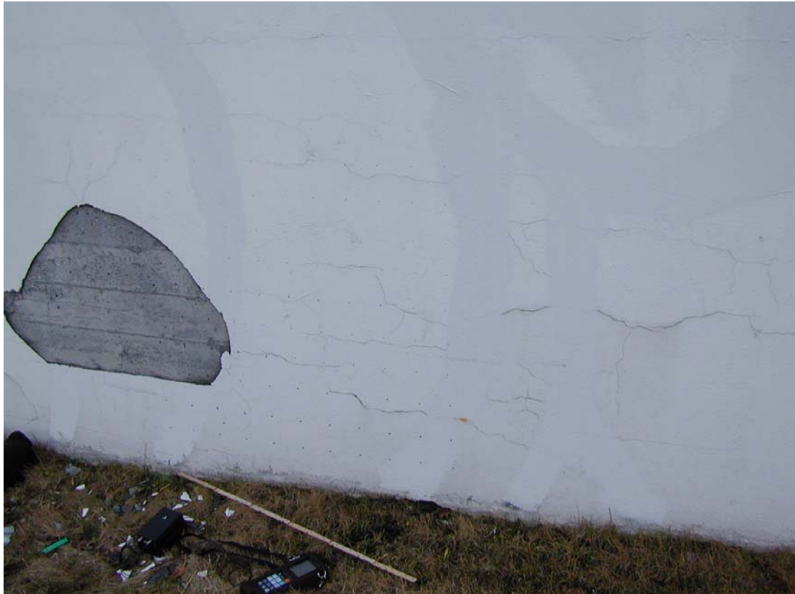
Mynd 9. Staðsetning á mælineti, mælt frá vinstri til hægri og byrjað upp, alls var mælt eftir 11 láréttum línum með 10 cm millibili. Múrinn er mislaus frá veggnum og sprungudýptin er milli 10 og 12 cm. Múrinn virðist ekki vera meira en um 1 cm á þykkt. NDT-tækið var stillt á 33 KHz og 3000 m/sek.
