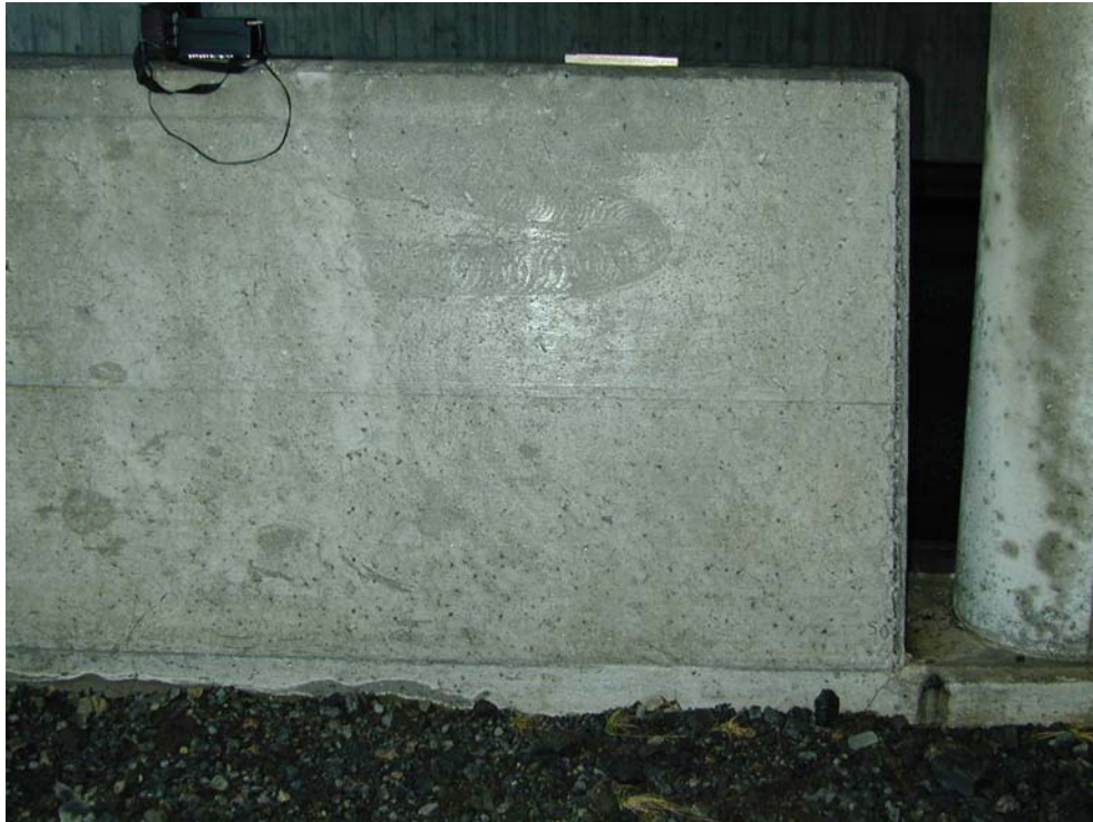
Mynd 16. Staðsetning mælipunkta. Mælt var frá efri brún eftir láréttum línunum frá vinstri til hægri, alls 10 línur. Hver lína var 1 m á lengd. 10 cm voru milli hvers mælipunkts. Tækið var stillt á 3000 m/sek og 33 KHz.
