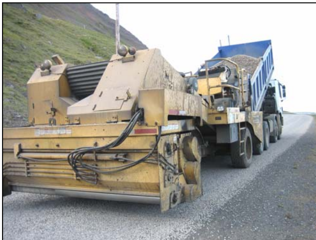
Mynd 9. Malardreifari sem notaður var við útlögn tilraunar-innar.
