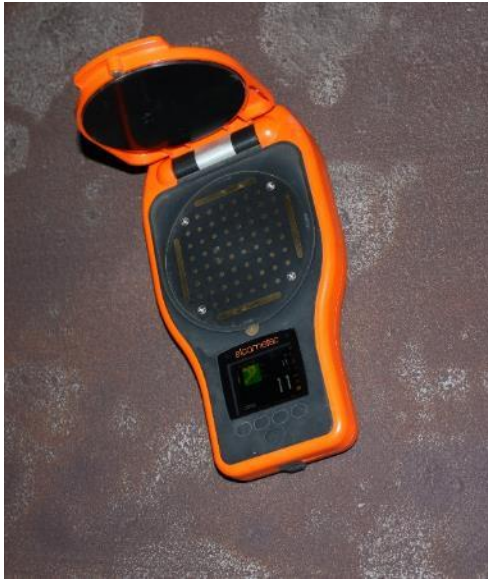
Mynd 6. Einn af mælunum sem notaðir voru til að mæla og skrá saltákomu, hita, raka og annað sem þurfti að fylgjast með á stálinu í brúarbitunum. Ljósmynd Sjótækni ehf.
