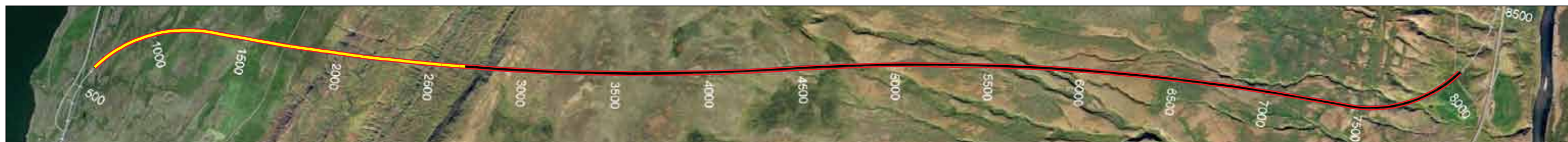
Vaðlaheiðargöng, staða framkvæmda 7. apríl 2014. Búið er að sprengja 2.039 m frá Eyjafirði sem er 28,4% af heildarlengd.
